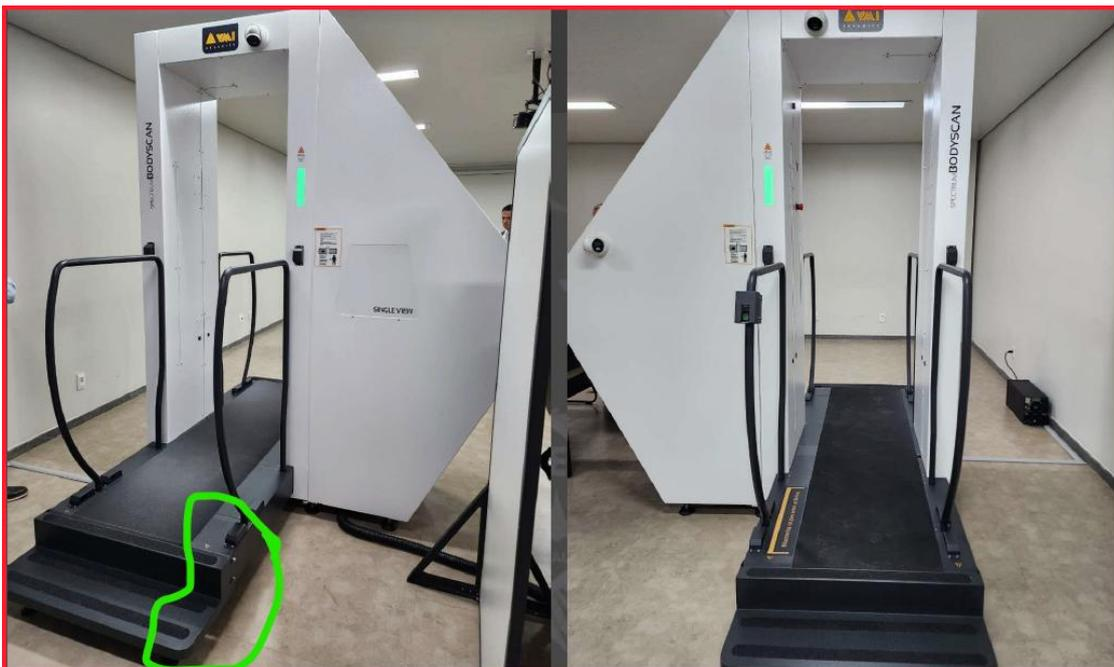
Ocorre que, de acordo com a Norma ABNT NBR 9050, temos como obrigatória a instalação de corrimão em degraus.
