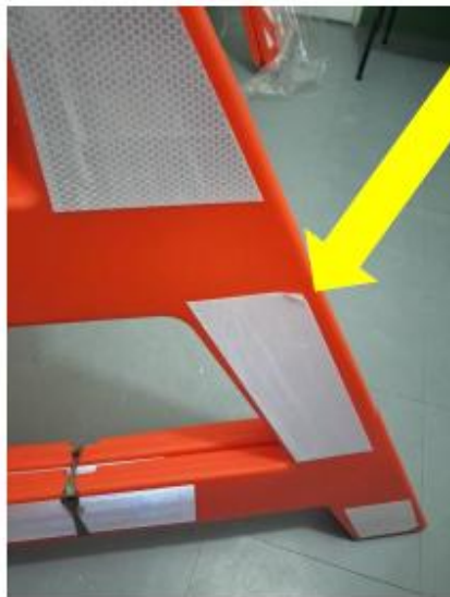
Imagem 01e 02 – faixas retro refletivas descolando da estrutura facilmente
