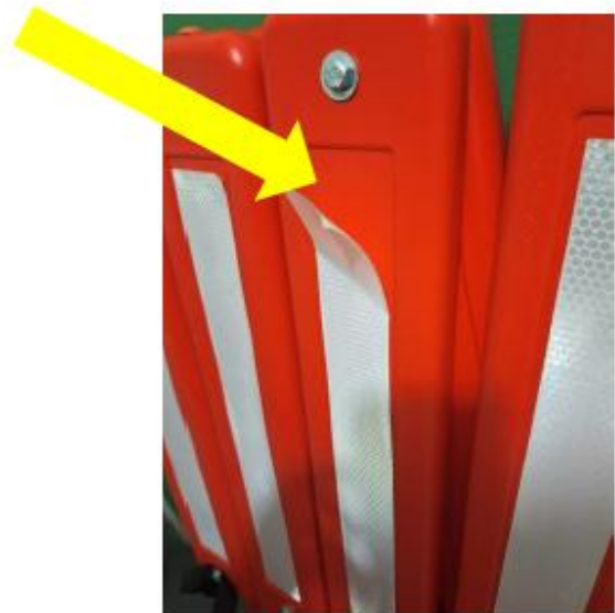
Imagem 01e 02 – faixas retro refletivas descolando da estrutura facilmente
